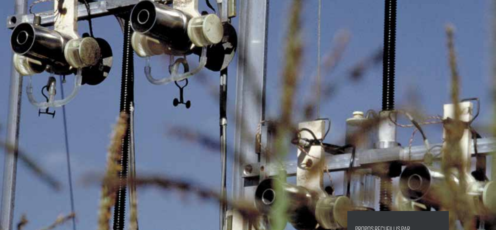
Batterie de psychromètres ventilés permettant de mesurer l'humidité de l'air à différents niveaux au-dessus d'une culture. © Inra - Pierre Cruiziat
