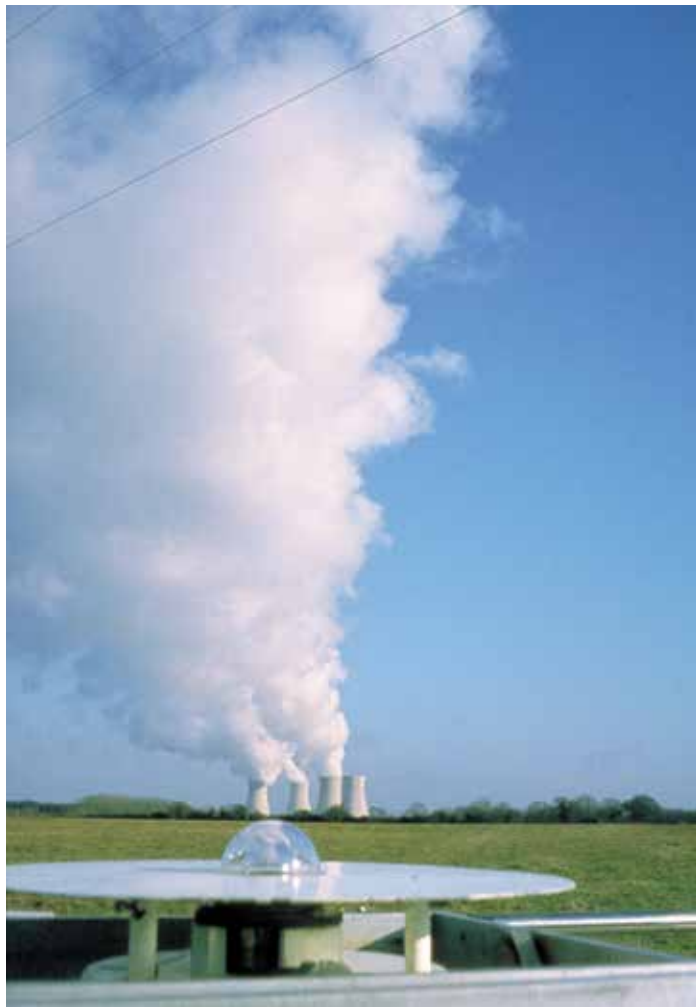
Étude de l'influence sur le climat des rejets thermiques des centrales électriques de grande puissance. Dampierre.
